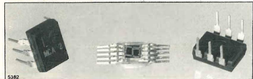
Il fotoaccoppiatore MCA 2 Monsanto (vedi figura) è in capsula di plastica « iso-dip » a sei reofori « dual-in-line ». L'isolamento fra entrata ed uscita è di  $10^{11}$  ohm e sopporta 1.500 V; inoltre non si hanno gli accoppiamenti dovuti al campo elettromagnetico dei relé. La prontezza d'intervento è di 10 microsecondi in eccitazione e di 35 microsecondi per la diseccitazione. La capacità fra entrata e uscita è di 1 picofarad. Il peso di solo 0,4 grammi.
