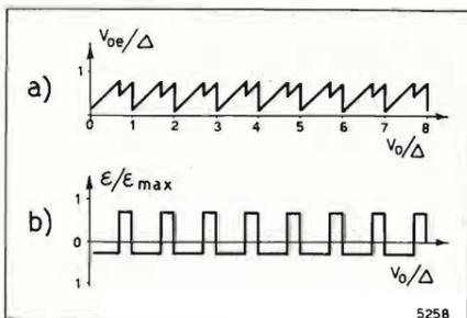
Fig. 6. — Andamento dell'errore di luminanza  $V_{oe}/\Delta$  e dell'errore di ampiezza  $\epsilon/\epsilon_{max}$  della sottoportante in funzione del livello di luminanza  $v_o/\Delta$  nel caso  $\alpha = 30^\circ$  (fig. 5);  $\epsilon_{max}$  è dato dalla [2].
