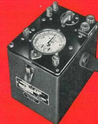
Fig. 4 - Contatore campione portatile
