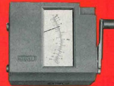
Fig. 7 - Misuratore di isolamento tascabile
