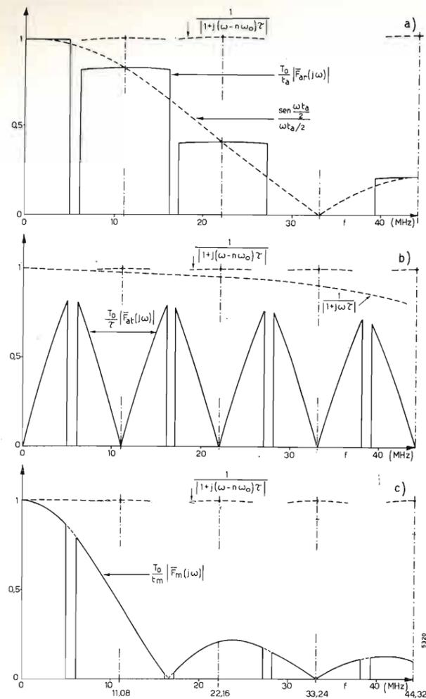
Fig. 5. — Spettro del segnale uscente dal primo campionatore nel caso in cui  $f_0 = 11,08$  MHz,  $\tau = 2,5$  ns,  $t_a = 30$  ns. a) spettro d'ampiezza della componente a regime  $v_{ar}(t)$ ; b) spettro d'ampiezza della componente transitoria  $v_{at}(t)$ ; c) spettro d'ampiezza della componente di memorizzazione  $v_m(t)$ .
