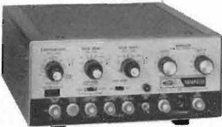
Modello 100A generatore di impulsi da 0,1 Hz a 10 MHz, compatto, economico a caratteristiche complete.
