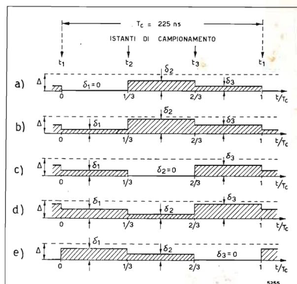
Fig. 3. — Tre configurazioni della forma d'onda di errore: a) prima configurazione; b) aumentando il livello di luminanza la configurazione non cambia finché  $\delta_2$  non diventa uguale a  $\Delta$  (intervallo di campionamento); c) e d) seconda configurazione; e) terza configurazione.
