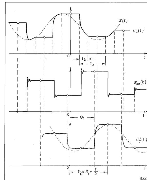
Fig. 7. — Andamento dei seguenti segnali:  $v(t)$  = tensione d'entrata del codificatore,  $v_c(t)$  = tensione uscente dal primo campionatore,  $v_{DA}(t)$  = componente utile della tensione uscente dal convertitore numerico-analogico,  $v_c'(t)$  = componente utile della tensione uscente dal secondo campionatore.
