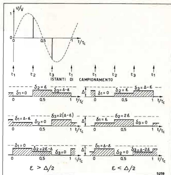
Fig. 7. — Le tre configurazioni della forma d'onda di errore nel caso  $\alpha = 0^\circ$  sono diverse secondo che:  $\epsilon$  (errore sul secondo campione) è maggiore di  $\Delta/2$  (a sinistra) o minore di  $\Delta/2$  (a destra).
