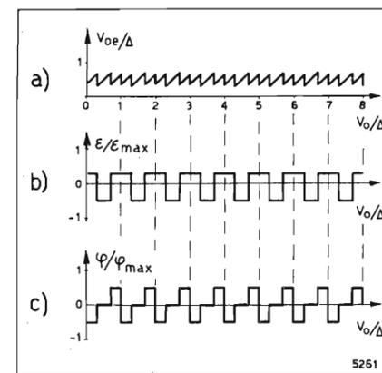
Fig. 9. — Andamento dell'errore di luminanza a) e degli errori di ampiezza b) e di fase c) della sottoportante in funzione del livello di luminanza  $v_o/\Delta$  nel caso di figura 7 per  $\epsilon > \Delta/2$ ;  $\epsilon_{max}$  e  $\varphi_{max}$  sono dati rispettivamente dalle [2] e [3].
