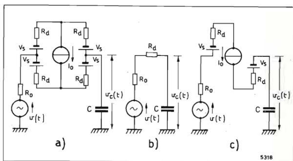
Fig. 3. — Schematizzazione di un circuito di campionamento e memoria reale durante la fase di acquisizione: a) sostituzione dei diodi con un generatore di tensione  $V_s$  continua con una resistenza in serie  $R_d$ ; b) sostituzione dell'intero ponte di diodi con una resistenza  $R_d$ ; c) caso analogo in cui è soddisfatta la [1].
